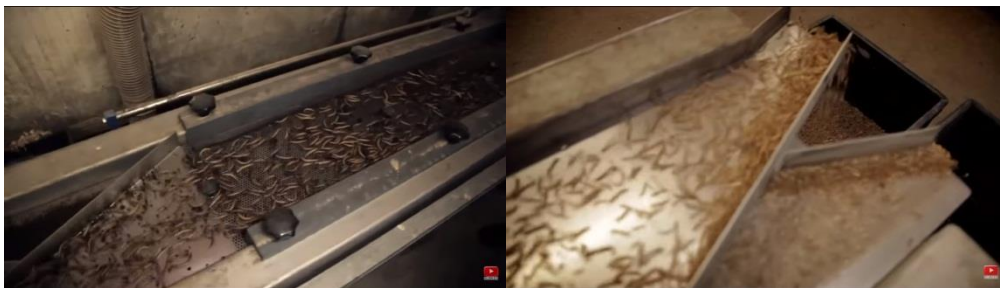
Figura 10 – Cinta transportadora-tamizadora para separación de larvas de su sustrato (Protifarm, Holanda).
